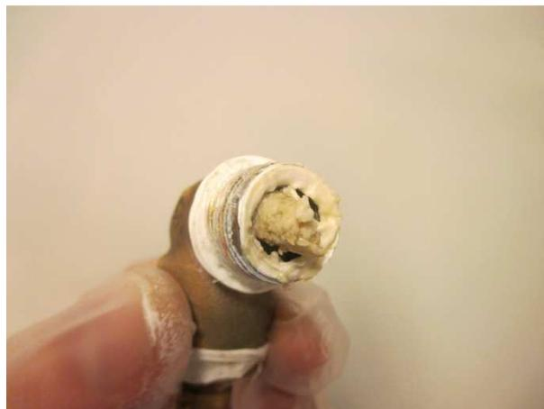
Além de afetar o fluxo de líquido dentro do sistema, os sólidos formados afetaram também a saída do gás do reator gerador de  $O_3$  (Figura 27), o que pode afetar a capacidade de geração de  $O_3$  devido à alteração na pressão do sistema.
