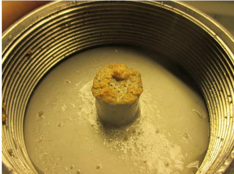
A Figura 27 mostra que ocorreu entupimento mesmo na parte superior do reator, onde não há contato direto com a fase líquida em tratamento. Isto mostra que parte dos sólidos formados no sistema é decorrente da solidificação da espuma que se formava apenas no processo inicial de ozonização.
