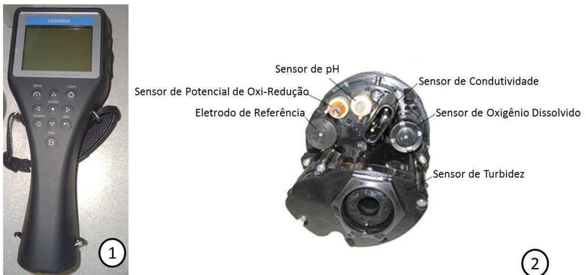
Figura 21: Controles da Sonda (1) e Sensores (2).
