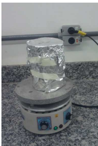
Figura 11 – Equipamento laboratorial utilizado no preparo da Fração Solúvel em Água (FSA) da Gasolina C.
