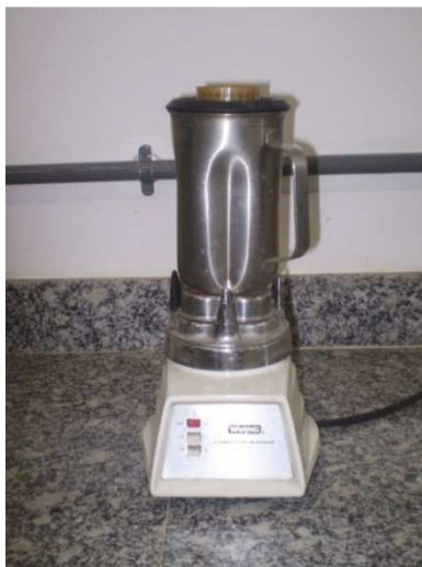
Figura 12 – Equipamento laboratorial utilizado no preparo da Fração Dispersa em Água (FDA) da Gasolina C.
