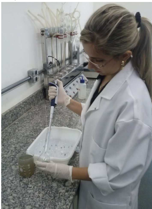
Figura 15 - Preparo das soluções-teste para o ensaio de toxicidade aguda com Daphnia similis .
