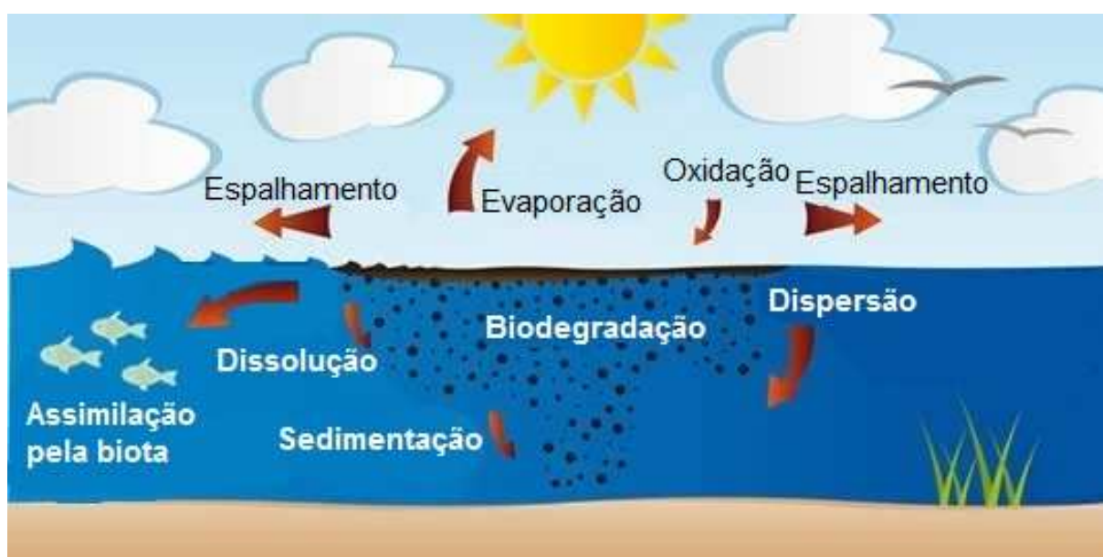
Figura 6 - Destino do contaminante (petróleo ou derivados) derramado, mostrando os principais processos de intemperismo.
