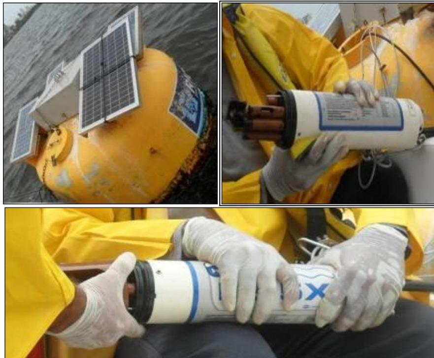
**Figura 23. Visualização geral da boia de amarração e dos processos de limpeza e manutenção da sonda multiparamétrica.**
