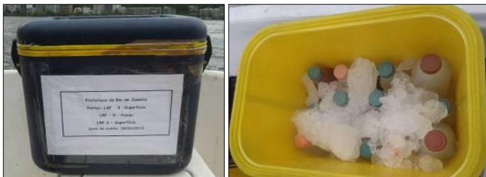
**Figura 18.** Preservação de amostras com gelo em caixas térmicas identificadas.
