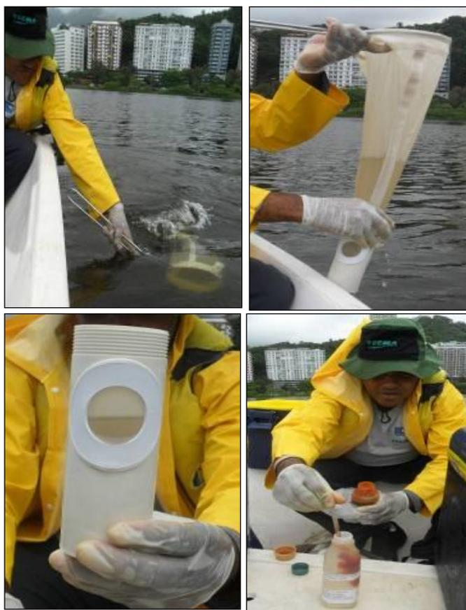
Figura 22. Sequência de fotos mostrando a coleta, acondicionamento e fixação de amostras de água para análise de fitoplâncton.
