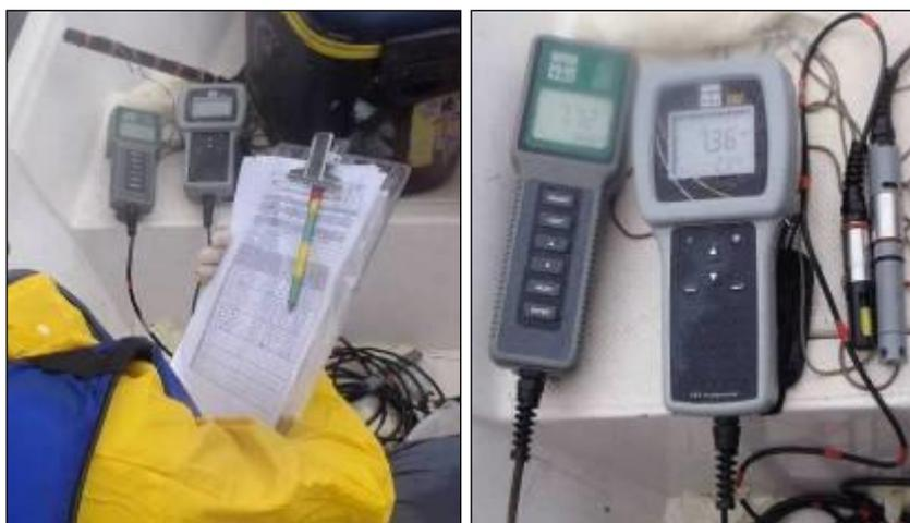
**Figura 21.** Anotação em campo dos dados obtidos *in situ* através de sondas multiparamétricas.
