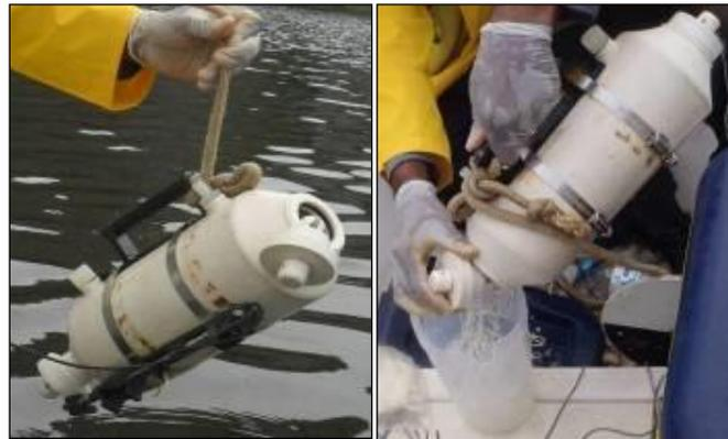
**Figura 17.** Amostragem de água com garrafa de van Dorn.
