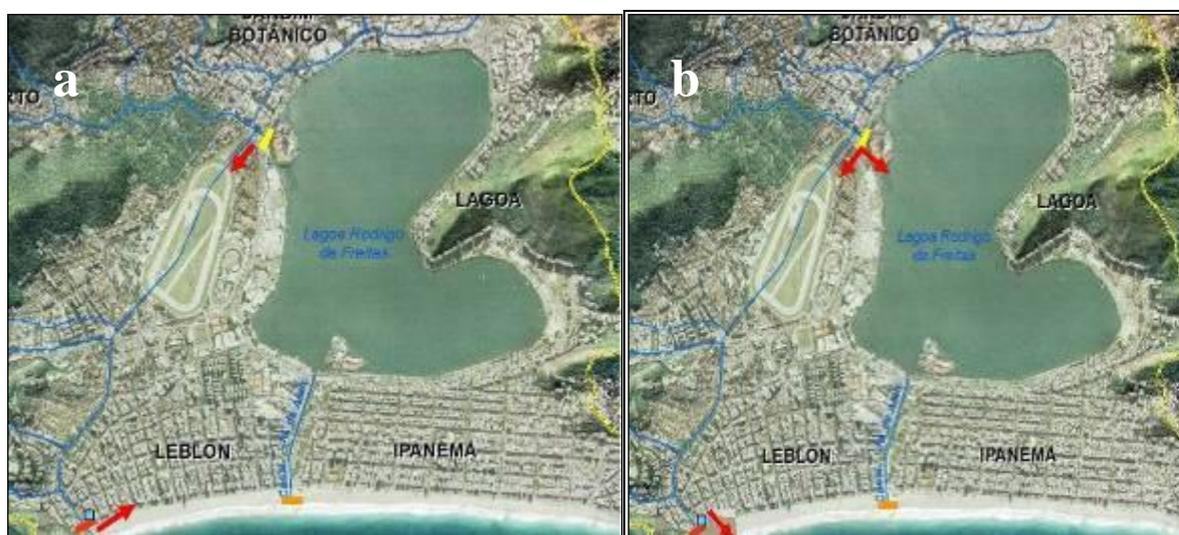
Figura 6. (a) Localização das comportas e elevatória. Fluxos de escoamento predominantes nos canais da LRF, em função da operação das comportas: (a) período seco; (b) período chuvoso.
