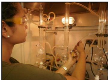
Figura 33: Secagem de THF destilado.
