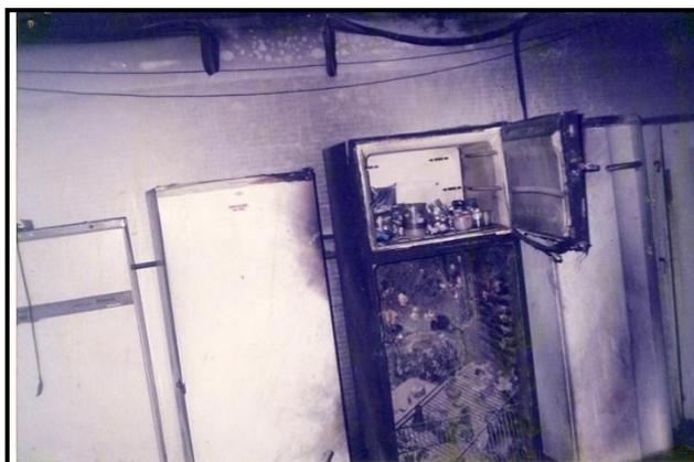
Figura 3: Geladeira doméstica em laboratório, onde se iniciou o incêndio.
