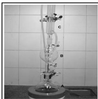
Figura 21: Sistema de secagem de THF
