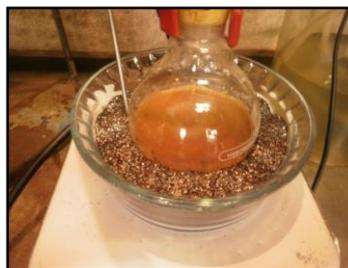
Figura 34: Aquecimento em chapa elétrica com grafite
