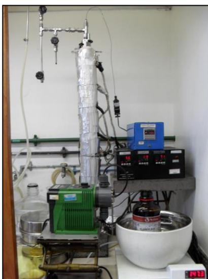
Figura 24: Sistema de adsorção em bancada.
