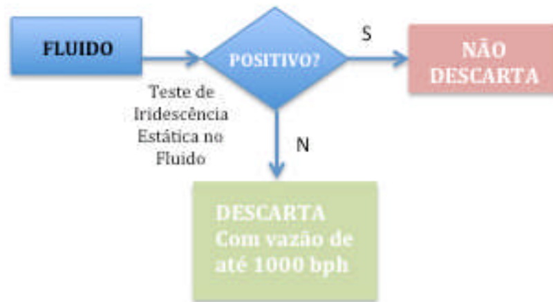
Figura 16 - Descarte de fluido de base aquosa
