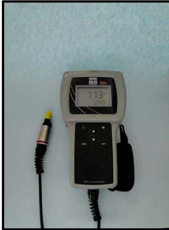
Figura 5.4. Oxímetro utilizado nos ensaios de teste de respiração.
