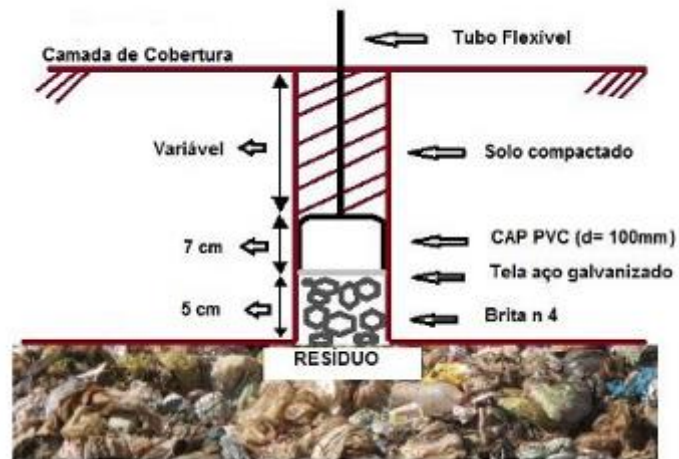
Figura 27 – Esquema do dispositivo de DMPC
