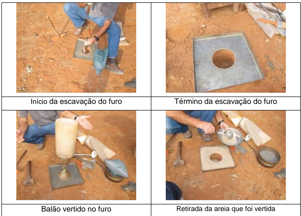
Figura 42 – Detalhe dos procedimentos do método frasco de areia.
