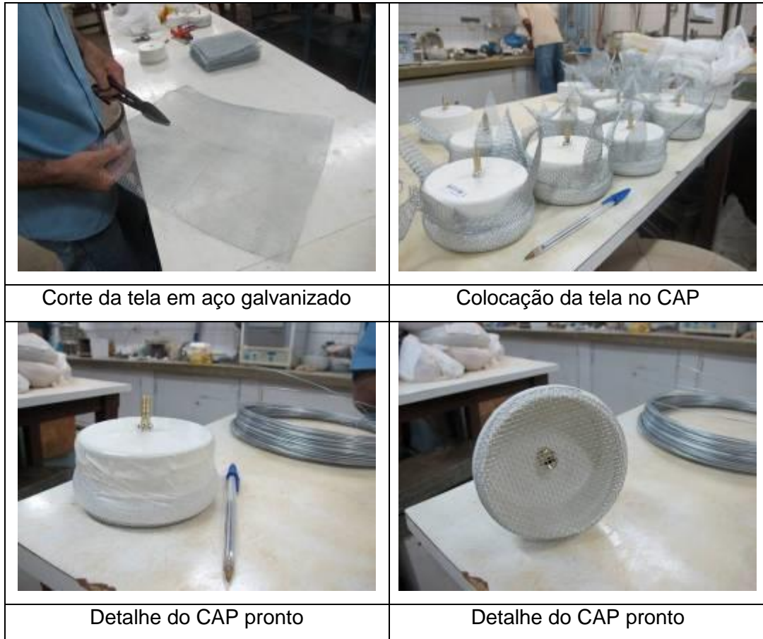
Figura 26 – Detalhe da fabricação do dispositivo de DMPC.
