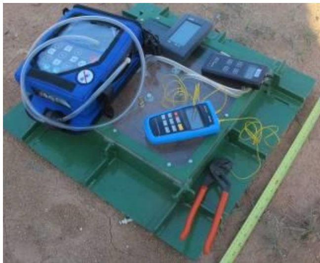
Figura 31 – Detalhe da placa de fluxo utilizada em campo e demais equipamentos.
