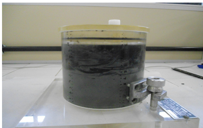
Figura 3.9: Célula de difusão montada.
