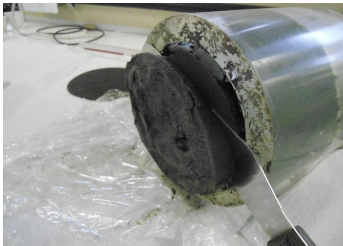
Figura 3.10: Foto do fatiamento da massa de solo da célula de difusão.
