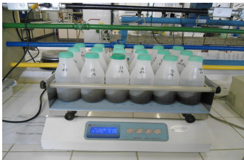
Figura 3.7: Foto dos frascos com as amostras sendo agitadas no shaker.
