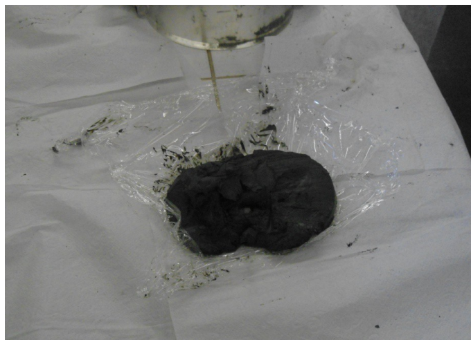
Figura 3.11: Foto da fatia da massa de solo em plástico-filme.
