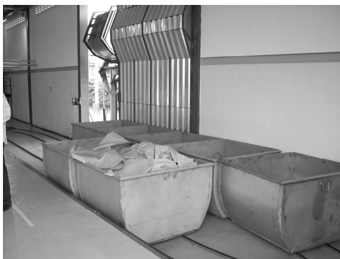
Figura 12 – Carros para introdução da carga na autoclave Fonte: Aborgama do Brasil
