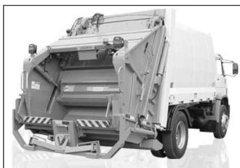
Figura 29 – Caminhão compactador para resíduos sólidos Fonte: USIMECA, 2012
