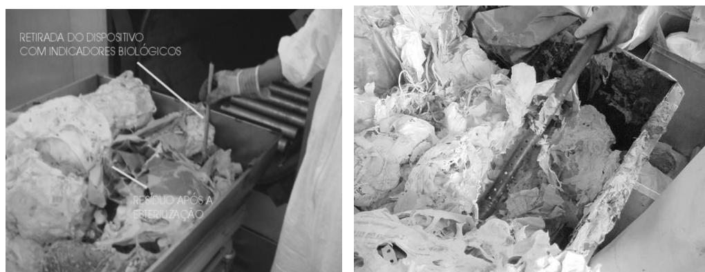
Figura 10 – Retirada do sensor do interior da carga Fonte: Baumer, 2008
