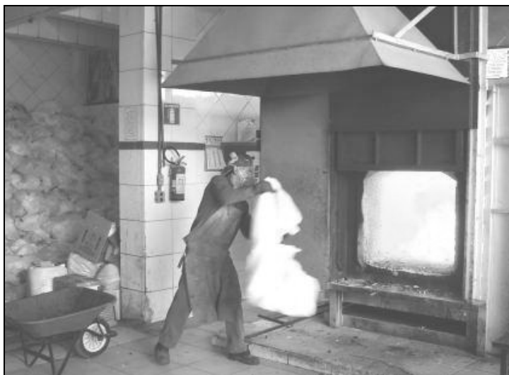
Figura 17 – Alimentação de resíduos A4 em forno para incineração Fonte: Pioneira, 2008
