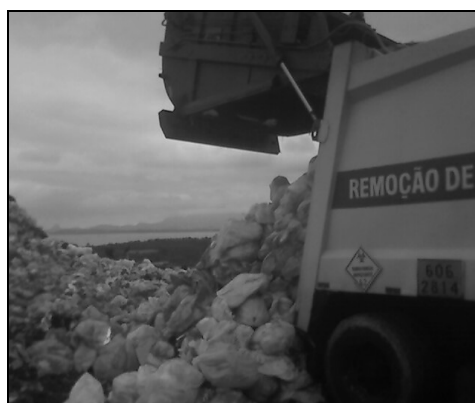
Figura 31 - Descarga de resíduo biológico por caminhão de baixa compactação Fonte: Autor, 2008
