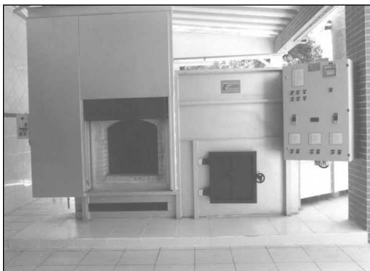
Figura 16 – Forno com duas câmaras para Resíduos Biológicos Fonte: Pioneira, 2008
