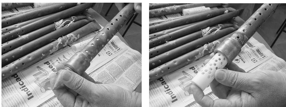
Figura 9 - Sensor sendo preparado para inserção na carga de teste Fonte: Baumer, 2008
