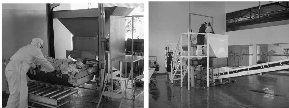
Figura 5 – Trituração do resíduo biológico após inativação microbiana Fonte: Baumer, 2008
