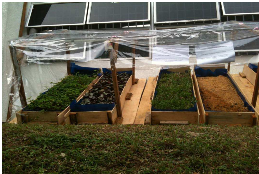
Figura 4. Experimento em escala piloto para a avaliação da retenção hídrica utilizando três diferentes tipos de vegetação e controle. Fonte: NAZYRA et al (2011).
