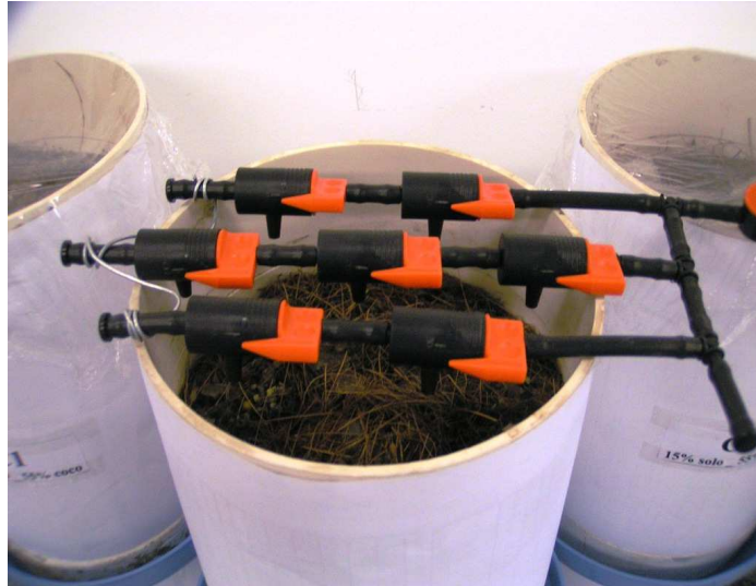
Figura 11: Sistema de irrigação das colunas (gotejamento).
