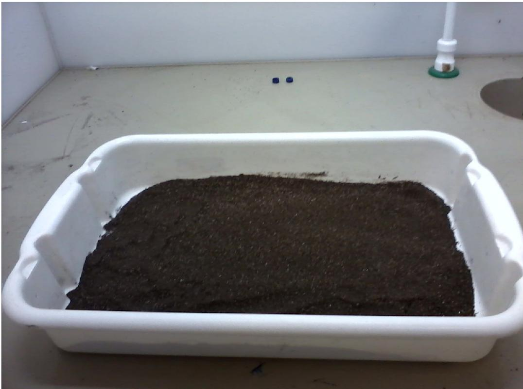
Figura 10: Solo arenoso homogeneizado após a contaminação com OLU a 5%.
