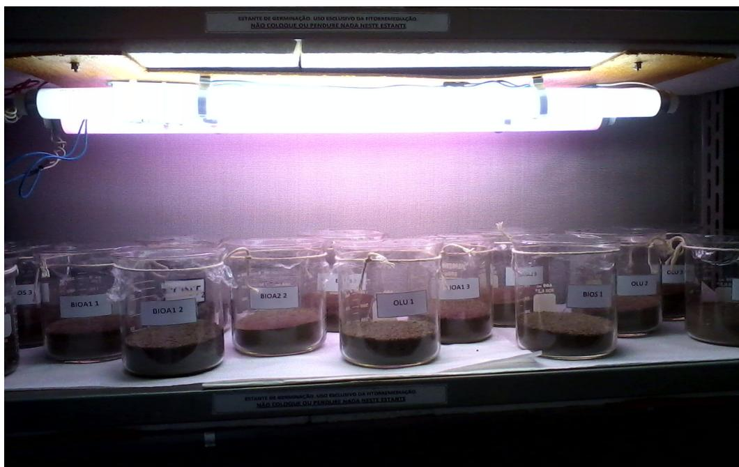
Figura 16: Disposição dos béquers com solo em estante para realização dos ensaios de toxicidade.
