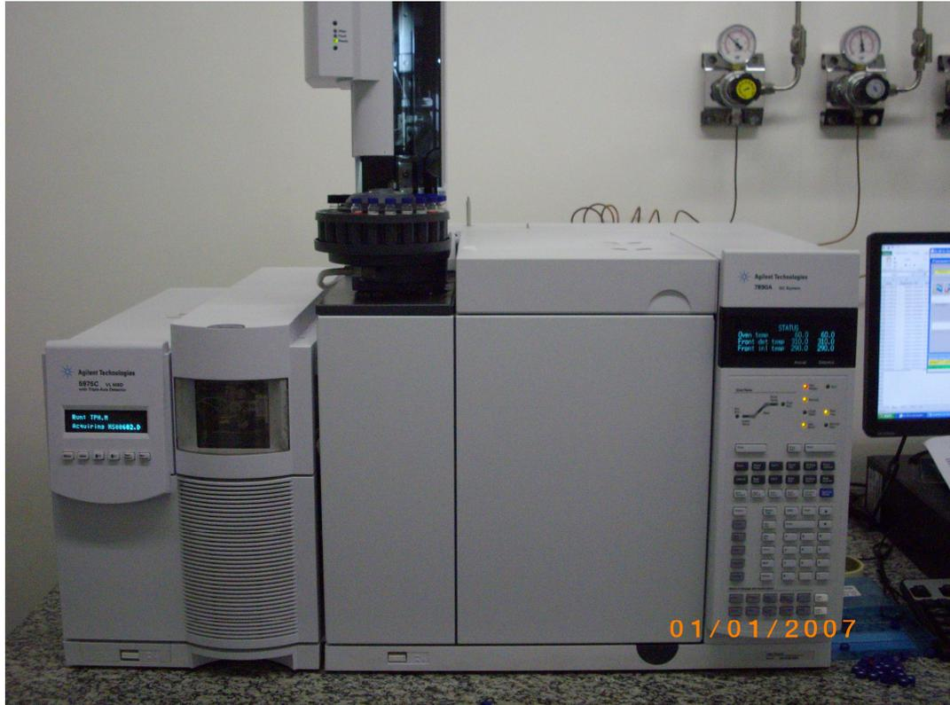
Figura 15: Cromatógrafo GC/MS Agilent7890A.
