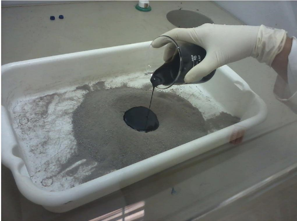
Figura 9: Contaminação do solo na concentração de 5% de Óleo Lubrificante Usado
