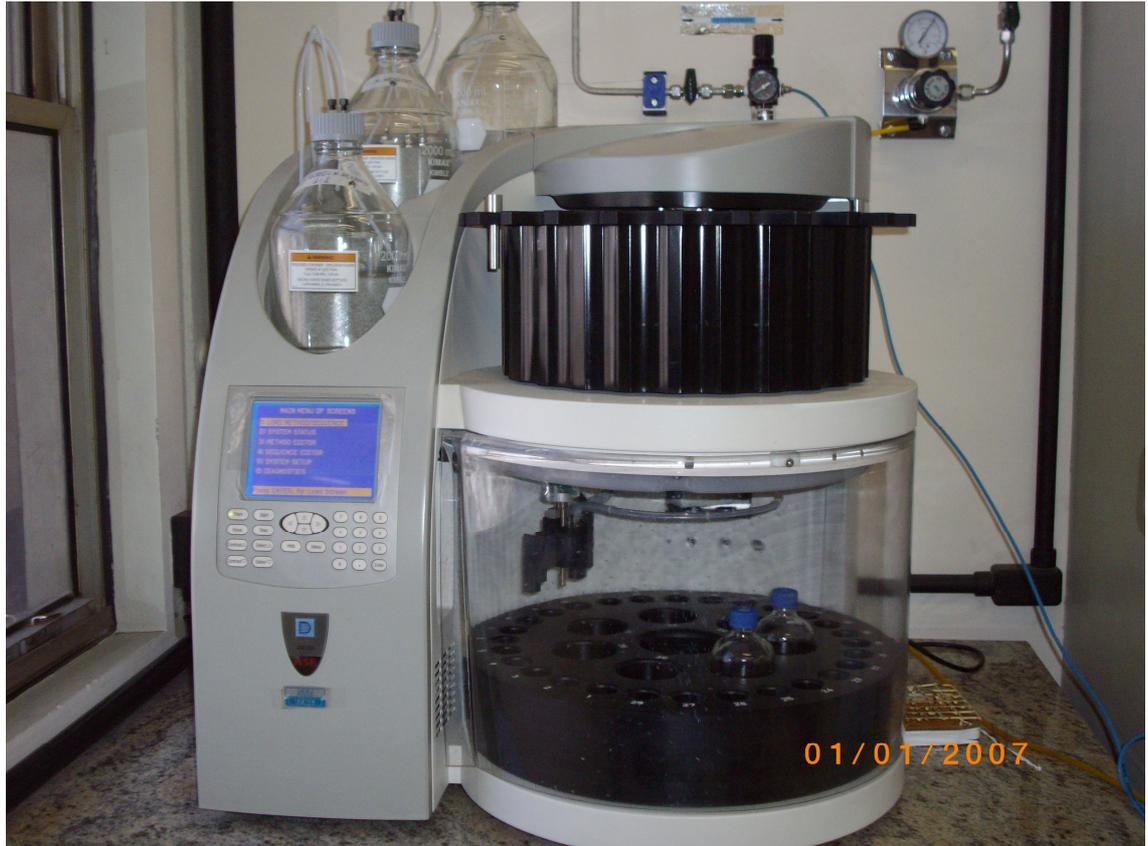
Figura 14: Extração por solvente acelerada (ASE).
