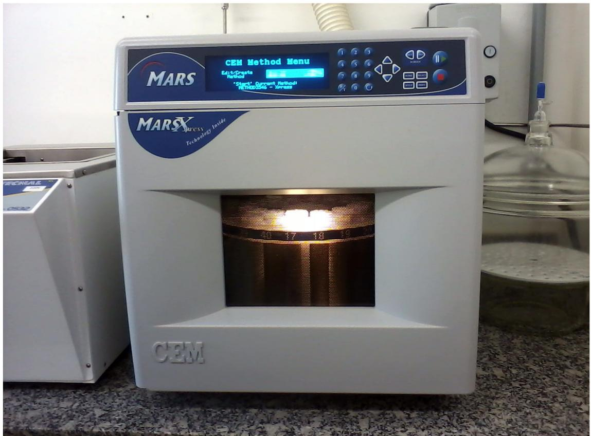
Figura 13: Extração realizada por micro-ondas.
