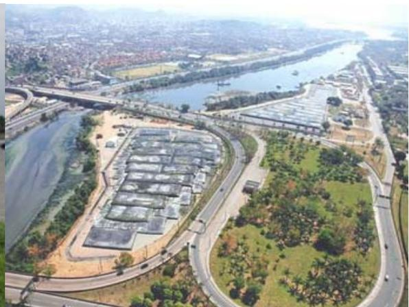
**Áreas com as unidades Geotube em funcionamento**
