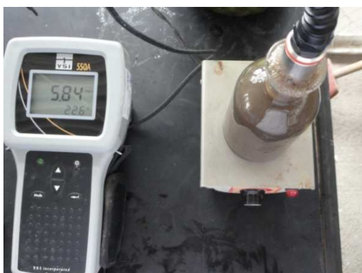
Figuras 3.5: Esquema do teste respirométrico – Oxímetro, agitador magnético e frasco de DBO com amostra.
