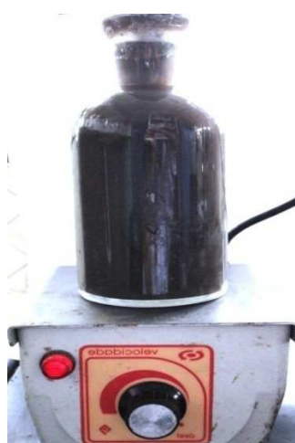
Figuras 3.5: Esquema do teste respirométrico – Oxímetro, agitador magnético e frasco de DBO com amostra.
