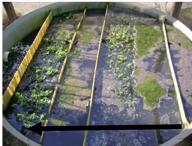
Figura 47 - Tanque de algas no dia 03/07/2010, com problemas de passagem de fluxo. A seta indica o sentido do fluxo.
