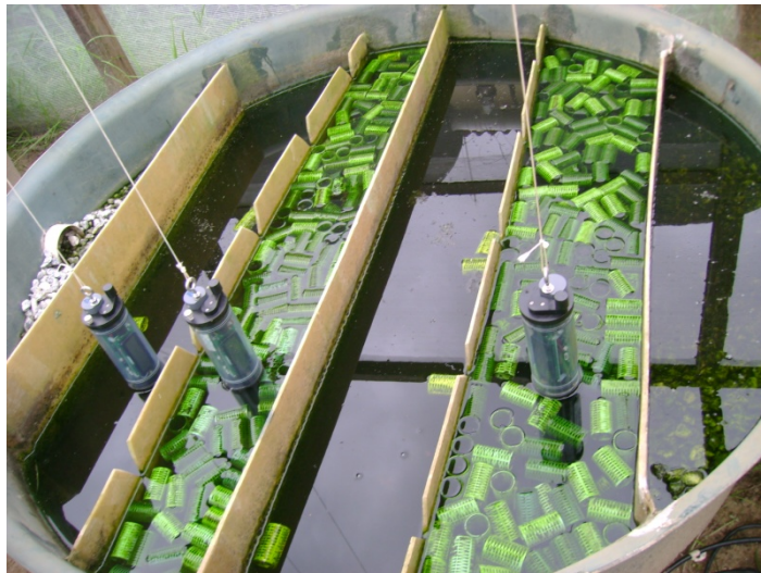
Figura 24 - Colocação dos sensores de oxigênio dissolvido no tanque de algas.
