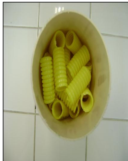
Figura 4.6: Acondicionamento do material de Recheio dentro da coluna
