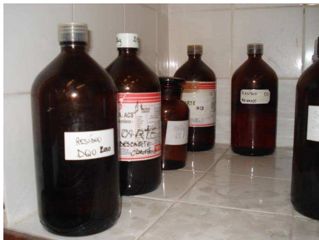
Figura 4 - Exemplo de rotulagem realizada no laboratório com a utilização de abreviações e a inexistência dos tipos de reagentes presentes nos frascos
