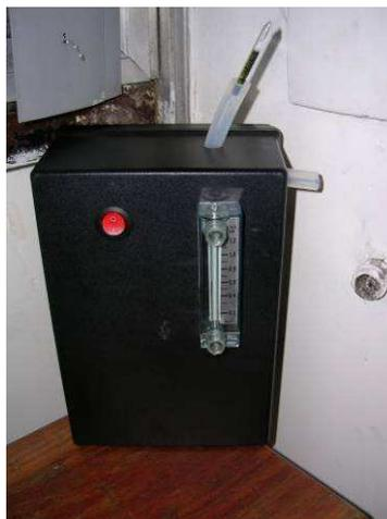
Figura 18 – Foto da Bomba KNF com cartucho de carvão ativado SKC acoplado.
