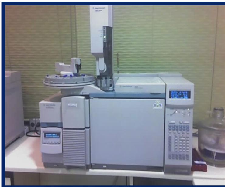
Figura 23 - Cromatógrafo a gás modelo 6890 acoplado a um espectrômetro de massa modelo 5973 da marca Agilent.
