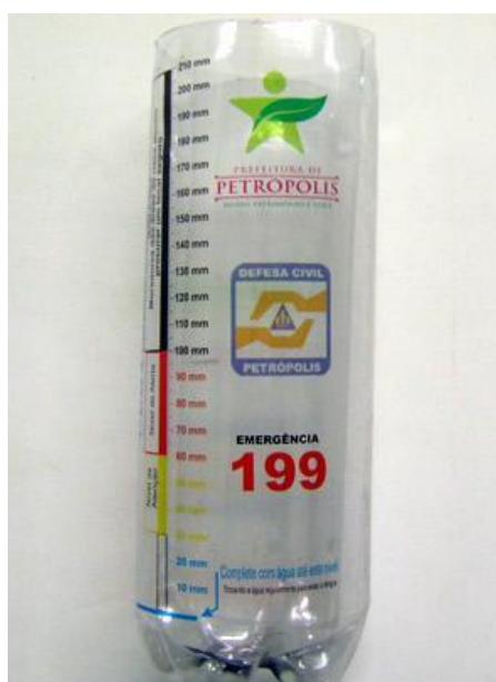
Figura 21 – Pluviômetro confeccionado com uma garrafa plástica pela COMDEC de Petrópolis. Fonte: Foto de Wilson Duarte.
