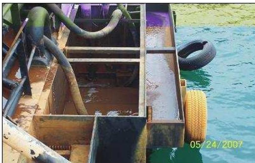
Figura 53 - Tanque de armazenamento das águas de lavagem, fixados lateralmente ao dique flutuante.
