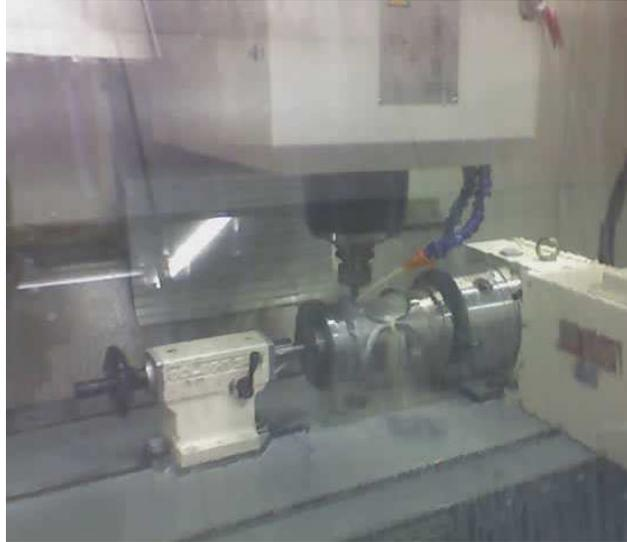
Figura 11 - Utilização de emulsão em máquina CNC.
