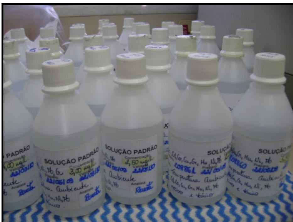
Figura 4.13. Soluções padrão utilizadas para a calibração do espectrômetro de absorção atômica.
