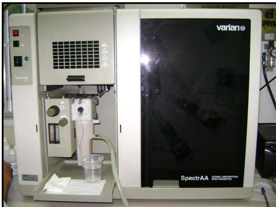
Figura 4.14. Espectrômetro de Absorção Atômica utilizado para leitura da concentração de metais nas amostras de lodo.
