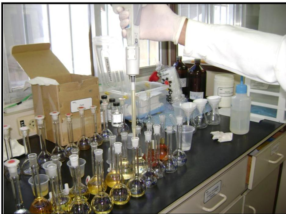
Figura 4.12. Amostras de lodo digeridas sendo diluídas para nova leitura em AA, quando suas concentrações de metais ultrapassam a curva de sensibilidade programada no espectrômetro.
