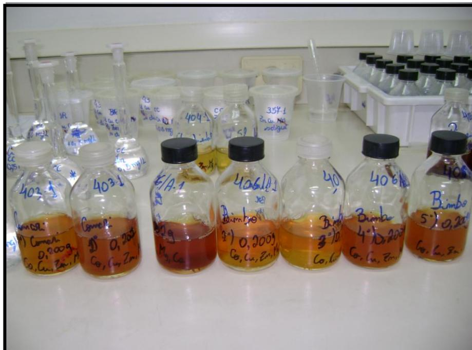
Figura 4.11. Amostras digeridas prontas para a leitura no espectrômetro de absorção atômica (AAS).
