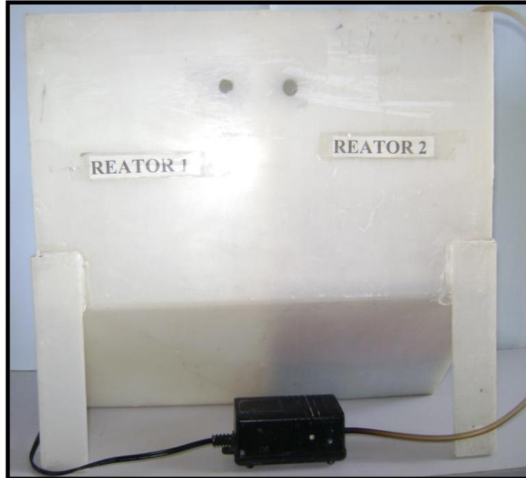
Figura 4. 1. Reator de lodos ativados em escala de laboratório antes do funcionamento.
