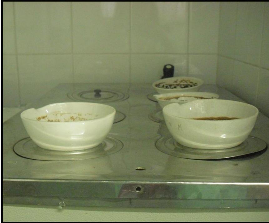
Figura 4.9. Amostras de lodo submetidas ao banho de 103°C na empresa TECMA (RJ).
