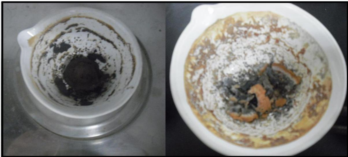
Figura 4.10. Amostra de efluente antes e depois de ser submetida à mufla a 550°C.
