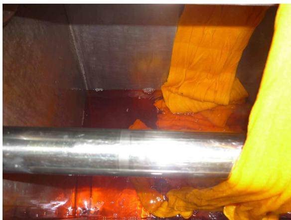
**Figura 10: Detalhe do tingimento do tecido de malha 100% algodão na barca piloto pequena com corante amarelo.**
