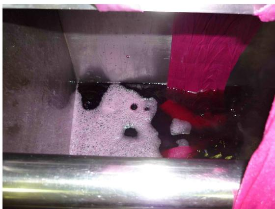
**Figura 11: Detalhe do tingimento do tecido de malha 100% algodão na barca piloto pequena com corante vermelho.**
