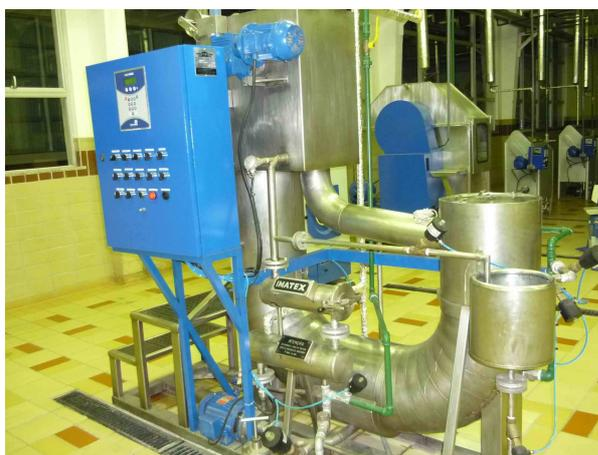
**Figura 5:** *over-flow* (Jet) em escala piloto.
