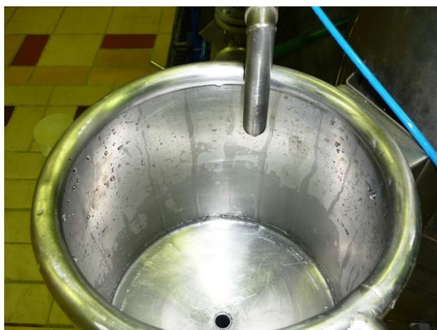
**Figura 9: Detalhe do compartimento de coleta de amostra no *over-flow*.**
