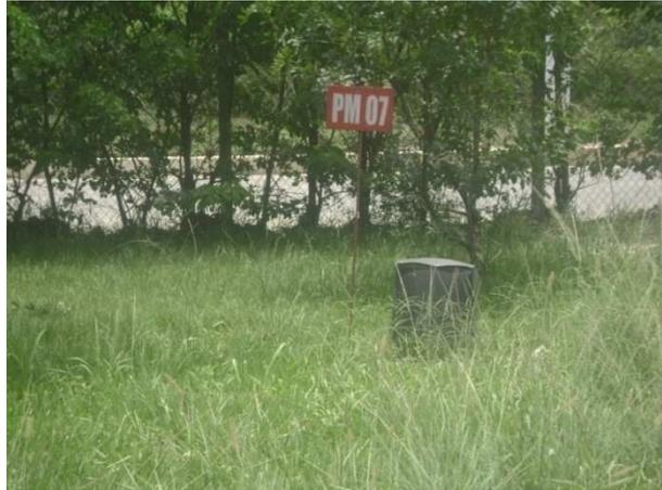
Figura 139 – Poço de Monitoramento de Água – CTR Nova Iguaçu
