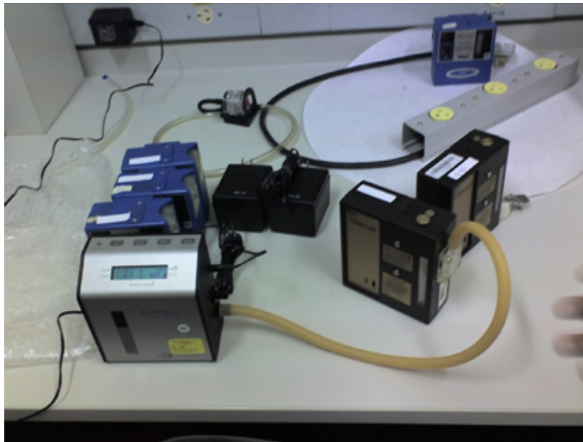
Figura 2.7: Amostrador SKC de baixos volumes sendo calibrado de forma automática com equipamento.
