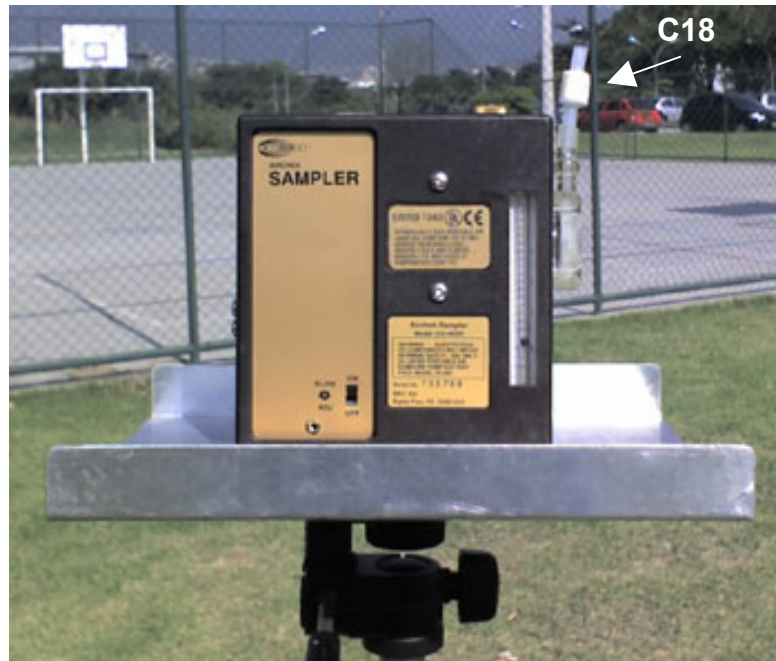
Figura 2.9: Amostrador de baixos volumes SKC com Cartucho C18 já conectado na lateral (direito superior), através de uma pequena borracha de silicone. Tripé instalado no Ponto A – Campo de Futebol da FIOCRUZ – a 1,5m de altura do solo.
