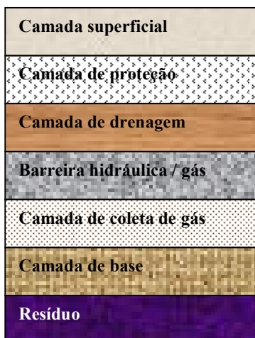
Figura 3.1: Camadas de um sistema de cobertura final
