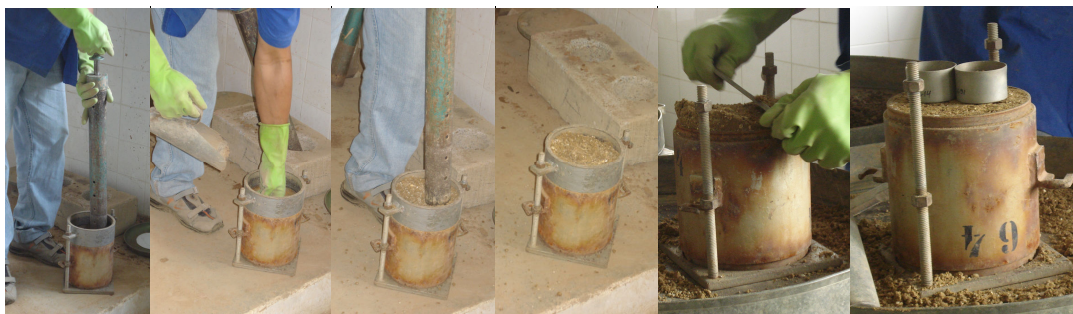
Figura 5.2: Sequência do ensaio de compactação
