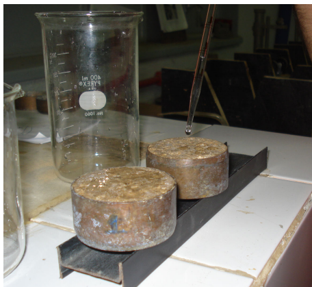
Figura 5.4: Umedecimento do corpo de prova até a saturação.
