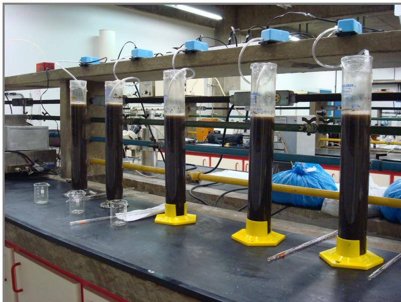
FIGURA 3.1 – SISTEMAS MONTADOS PARA ESTUDO DE BIODEGRADABILIDADE
