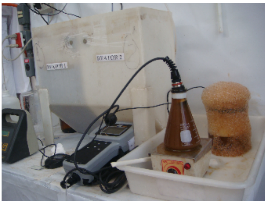
Figura 3.18 – Lodo espumando após variação brusca de pH: indústria alimentícia 01
