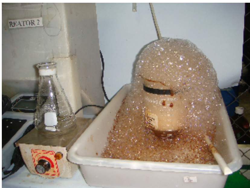
Figura 3.14 – Lodo espumando após variação brusca de pH: indústria farmacêutica
