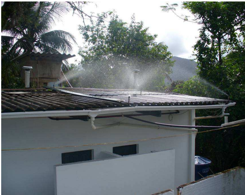
Figura 3.9 - Sistema de irrigação por aspersão utilizado para simular efeitos da chuva nos testes de conforto térmico interno e runoff superficial dos telhados.
