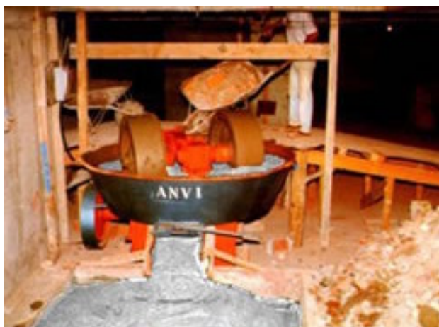
Figura 7. Moinho para reciclagem no canteiro de obras (ANVI, 2007).
