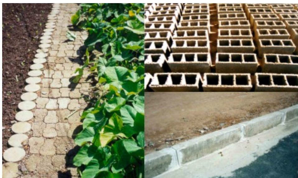
Figura 15. Elementos produzidos de concreto utilizando-se como agregados RCC reciclados - piso intertravado, blocos para alvenaria e guias para meio-fio (Prefeitura de Belo Horizonte, 2007)
