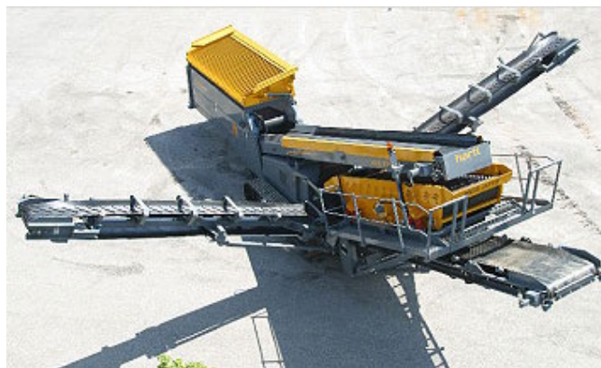
Figura 9. Peneiras móveis para segregação granular dos RCC ( www.powercrusher.com em dezembro de 2007)
