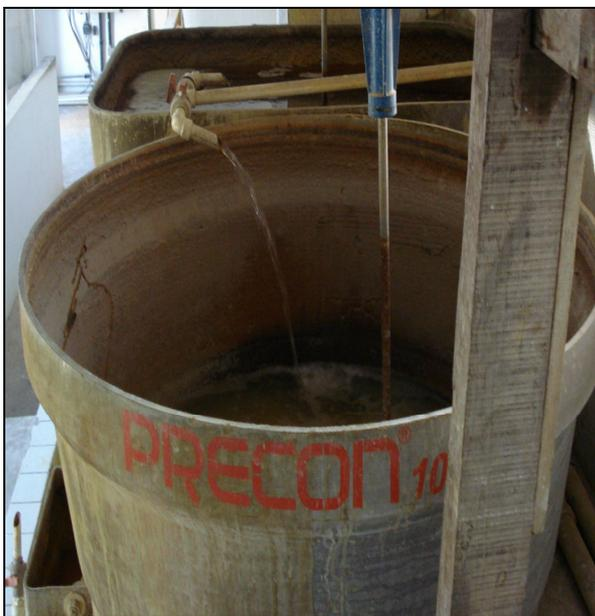
Figura 6.17 - Lavagem do tanque de sulfato.
