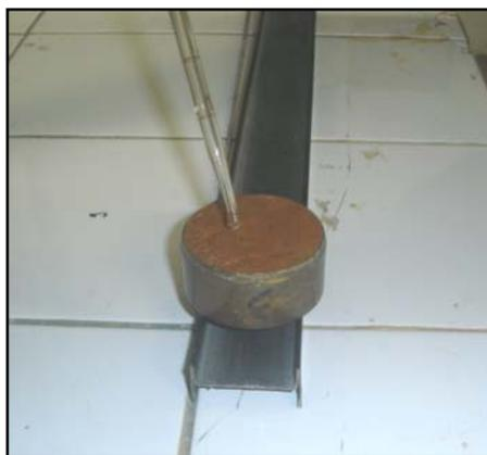
Figura 4.14 – Umedecimento do corpo de prova
