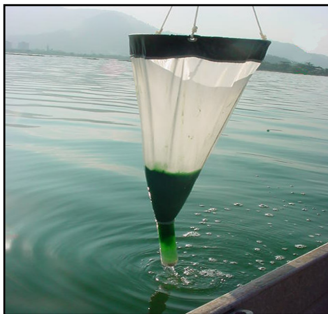
FIGURA 3.2 - Rede de plâncton – Utilizada para concentrar os organismos fitoplantônicos a serem identificados nas análises qualitativas. A massa verde- intenso, no interior da rede, refere-se ao concentrado de Cianobactérias e outras micro-algas.
