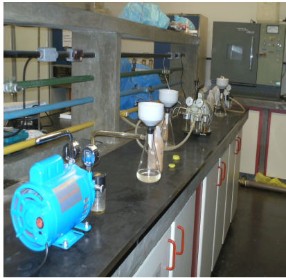
(a) Bomba de Vácuo Figura 13 - Conjunto de Filtração
