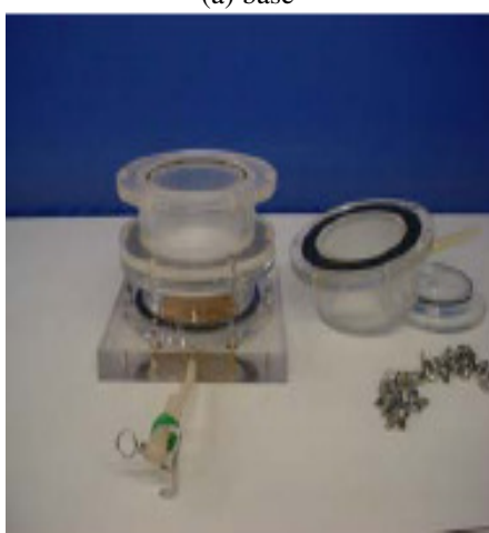
(c) reservatório de percolado
