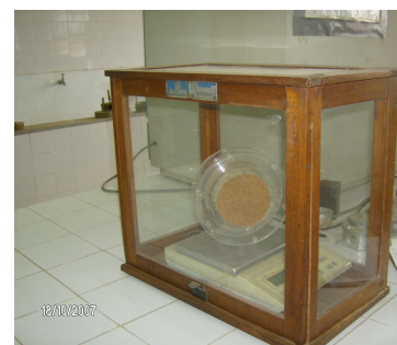
(c) pesagem reservatório de solo
