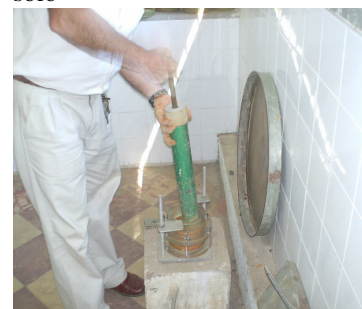
(f) compactação do solo no reservatório
