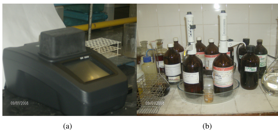
Figura 34 - Espectrofotômetro da HACH, modelo DR 2800 (a) e as soluções utilizadas para Determinação dos valores de DQO (b).
