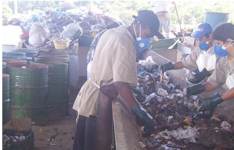
**Figura 19.** Triagem de resíduos em esteira mecanizada
