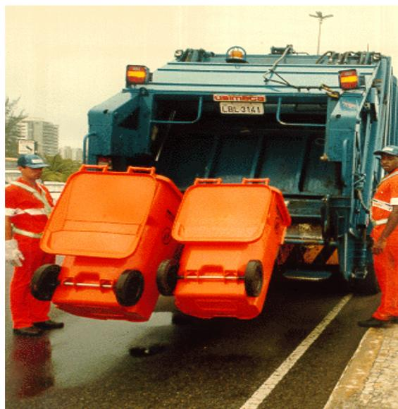
**Figura 5 – Veículo Compactador usando Sistema Bascular com Contêiner**
