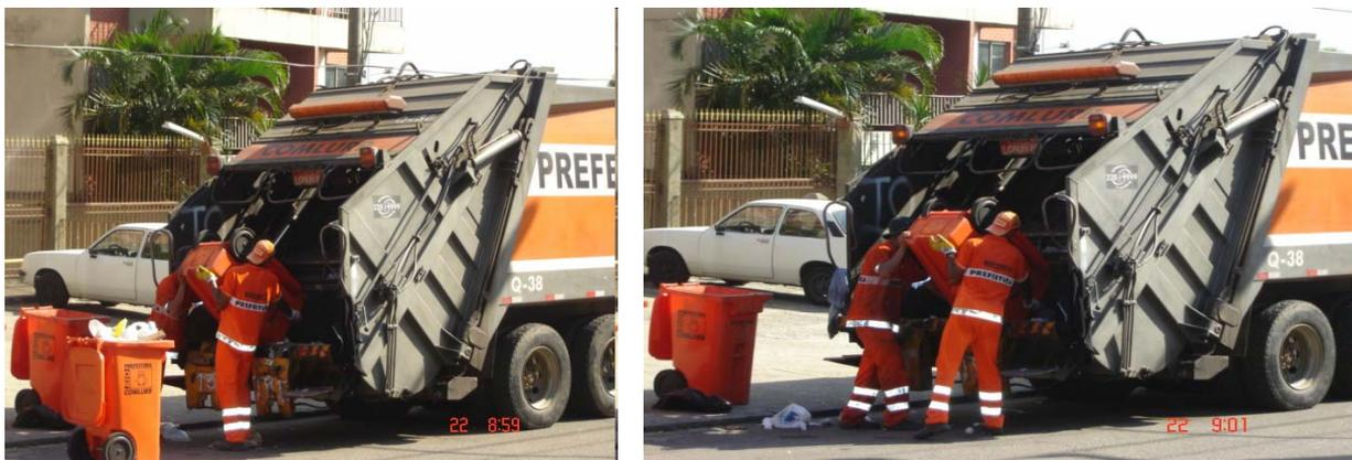
**Figura 6 – Garis utilizando Sistema de Elevadores de Contêineres**
