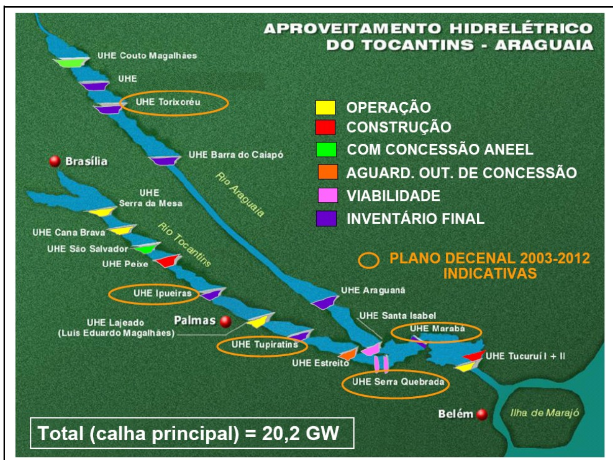
Figura 6. Configuração Topológica dos Principais Aproveitamentos Hidrelétricos dos Rios Tocantins e Araguaia. Fonte: ELETROBRAS, 1990.
