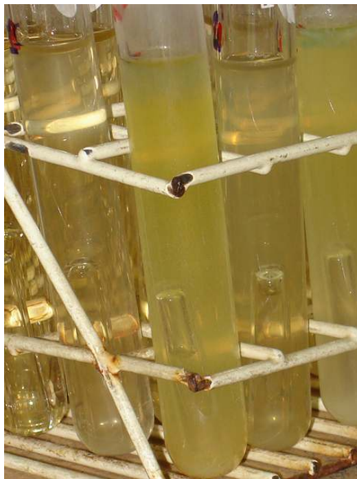
Figura 4.4. Tubos múltiplos apresentando tubos de Durham com gás e turvação do meio, prova presuntiva em caldo lactosado para presença de coliformes totais.
