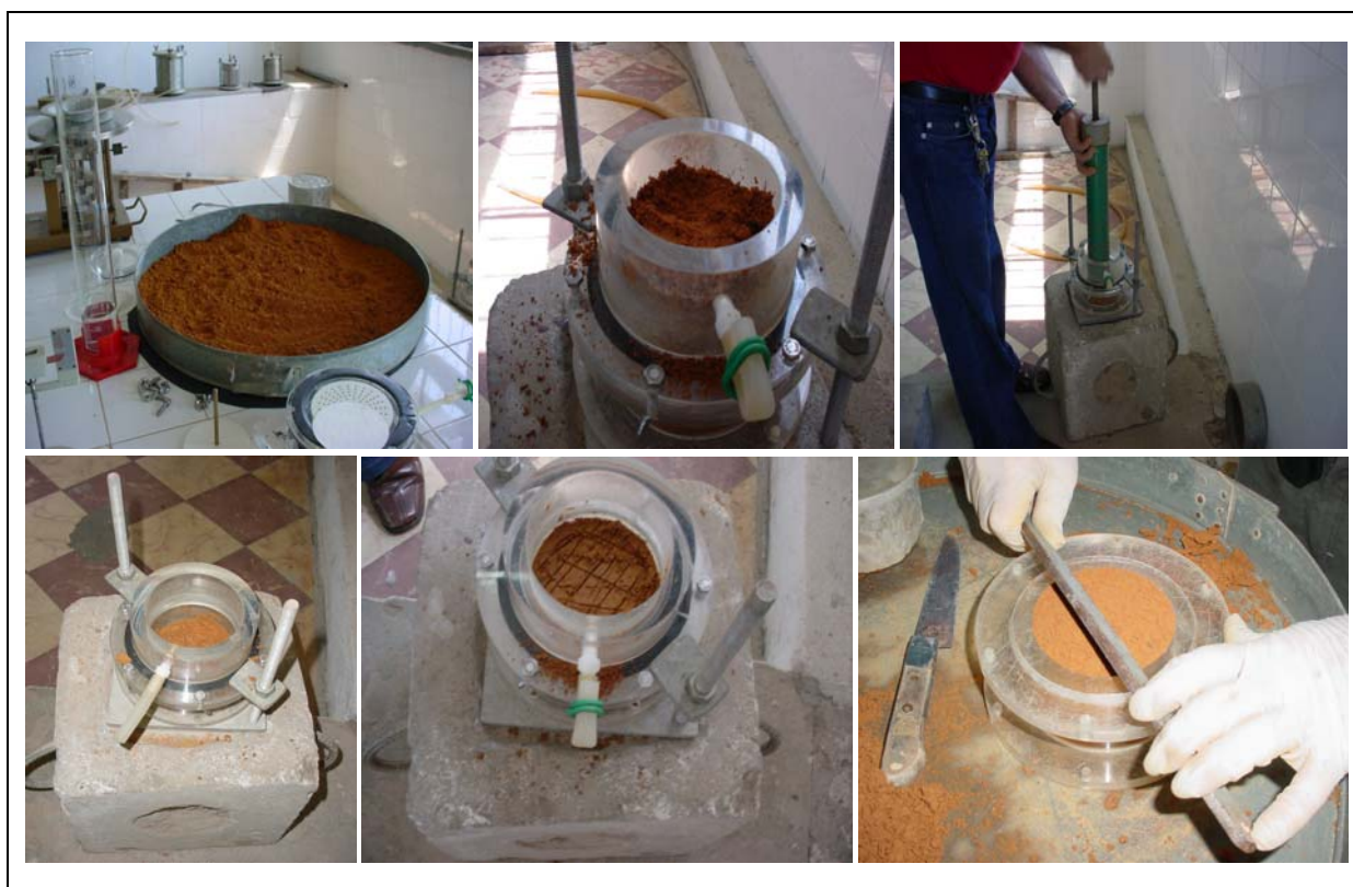
Fig. 4.8 – Seqüência de compactação
