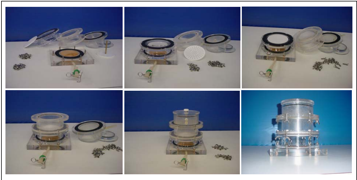
Fig. 4.7 – Célula de difusão (molde de acrílico)
