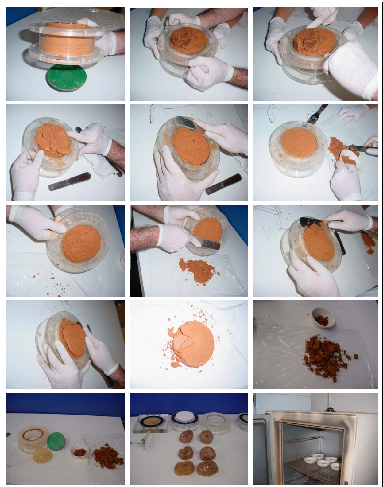
Fig. 4.13 – Seqüência de retirada do solo do molde
