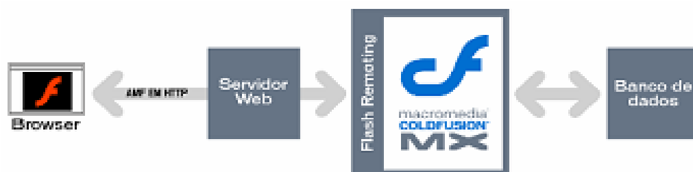
Figura 1.1 – Esquema de tecnologias empregadas para desenvolvimento do sistema.
