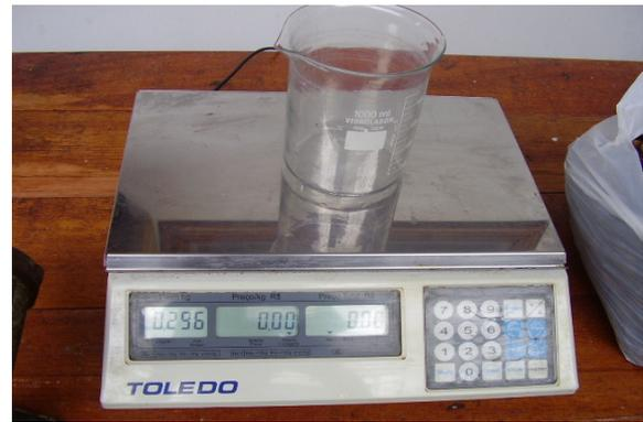
**Figura 41.** Foto do Detalhe do peso de Becker utilizado para pesagem e medição volumétrica das amostras de resíduos utilizados na determinação do peso específico
