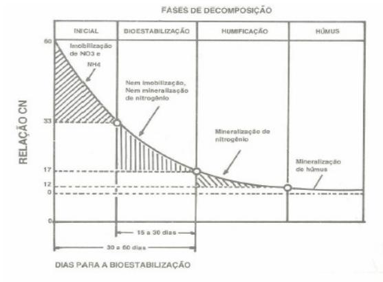
**Figura 28.** Fases de decomposição conforme relação C/N. Fonte: KIEHL (1985, pg. 257)
