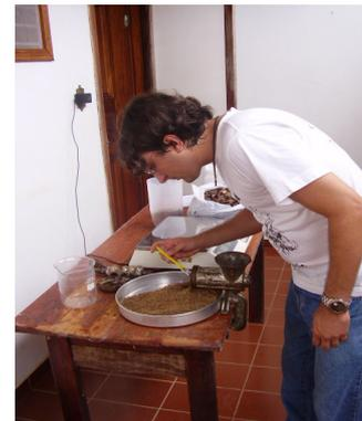
**Figura 47.** Ao término da trituração, a desmontagem e a limpeza do triturador para não perder os resquícios de resíduo que ficaram no interior do mesmo.
