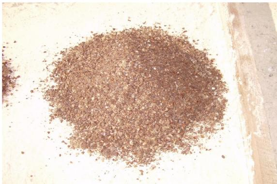
**Figura 75.** Detalhe da vista da Pilha 06. 10% Caroços de açai e 90% Cascas de castanha
