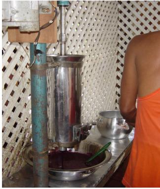
**Figura 08.** Foto de uma máquina bateadeira do açai que faz a extração do suco (separação da polpa e dos caroços). Fontes diretas de produção de resíduos “caroços de açai”, onde são recolhidos, segregados na origem, sem contato manual
