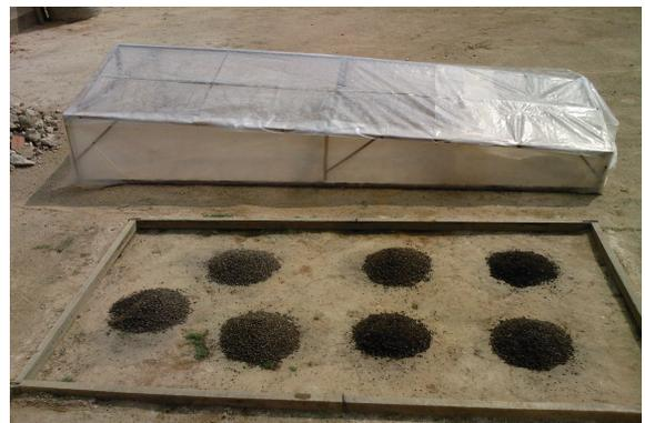
**Figura 78.** Detalhe da cobertura que foi construída para proteção contra fortes chuvas incidentes.
