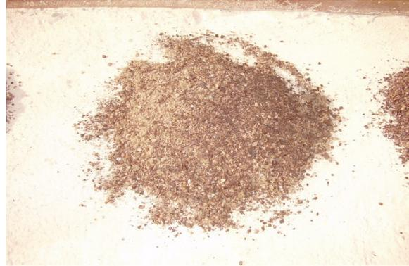
**Figura 74.** Detalhe da vista da Pilha 06. 25% Caroços de açai e 75% Cascas de castanha
