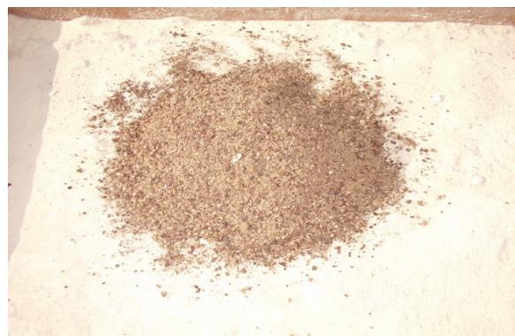
**Figura 72.** Detalhe da vista da Pilha 04. 75% Caroços de açáí e 25% Cascas de castanha
