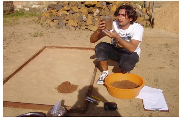
**Figura 62.** Medição volumétrica da quantidade de resíduos com o Becker. Montagem da Pilha 01, conforme a Tabela 10.
