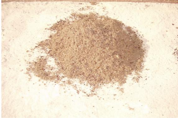
**Figura 73.** Detalhe da vista da Pilha 05. 90% Caroços de açai e 10% Cascas de castanha
