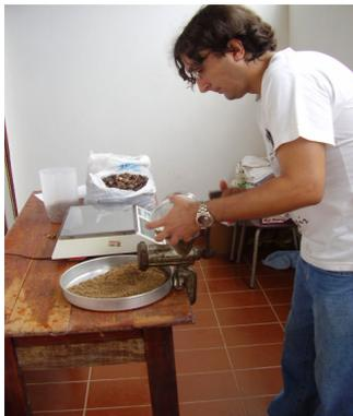
**Figura 46.** Trituração dos caroços de açaí. Processo muito difícil pelas características compactas dos caroços.
