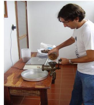
**Figura 45.** Após a anotação da pesagem e verificação do volume de 1 litro de resíduo, a transferência dos caroços de açaí para o triturador manual.
