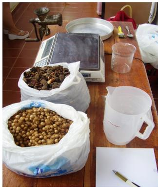
**Figura 40.** Foto da montagem e vista da bancada para o procedimento da determinação do peso específico dos resíduos.
