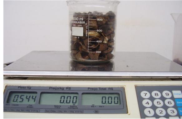
**Figura 51.** Detalhe da medição do peso e da quantidade volumétrica de cascas de castanha no Becker de 1 litro (a medida é visual, na marcação, por acomodação normal, sem compactação no Becker).
