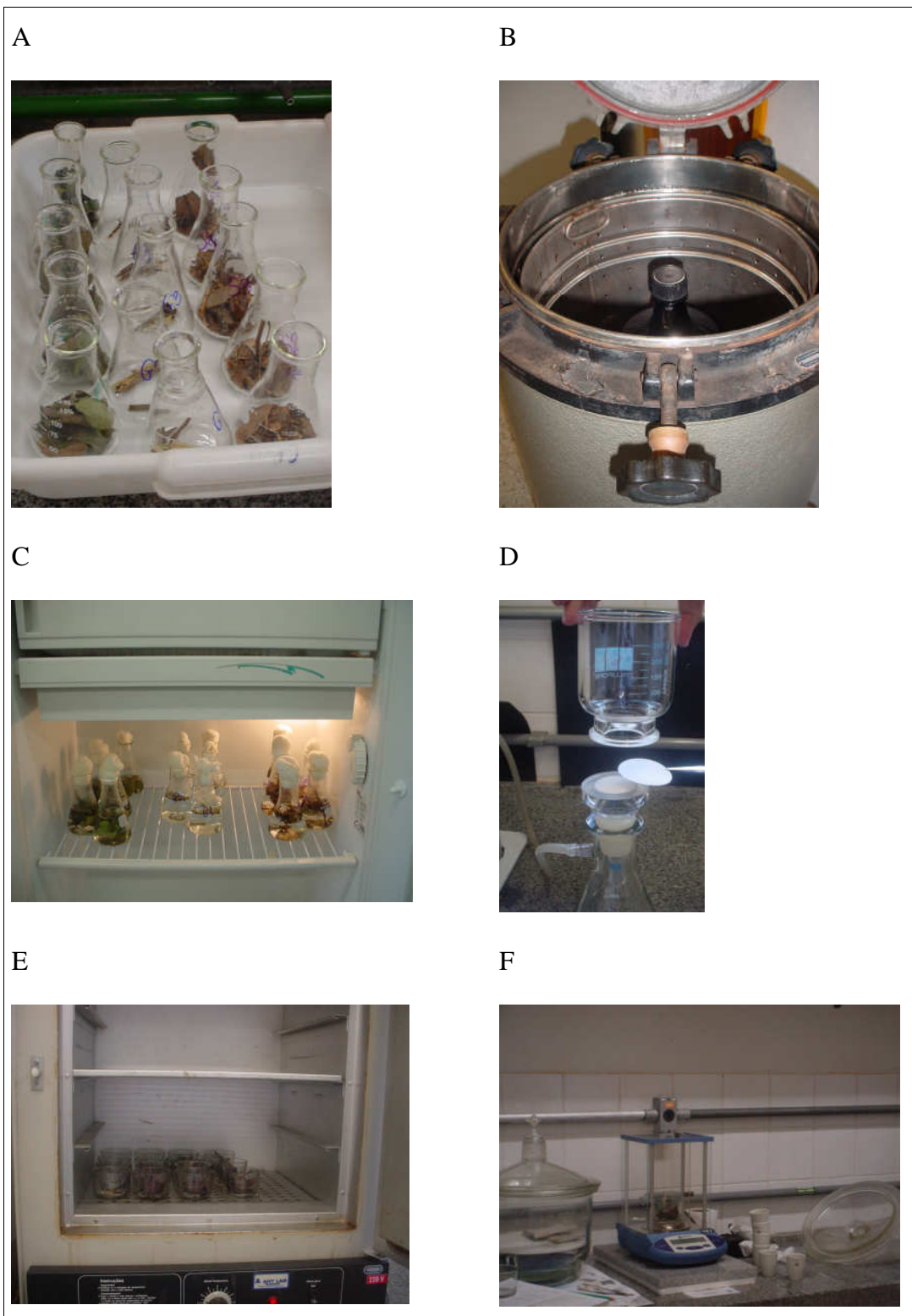
Figura 9 - Procedimentos experimentais do ensaio de lixiviação de folhas, galhos e serapilheira: (A) amostras dos recursos vegetais, (B) esterilização da água deionizada utilizada no experimento, (C) incubação do material vegetal a 4°C por 24 h, (D) preparação do processo de filtração do material vegetal, (E) secagem do material filtrado e (F) determinação da massa remanescente após a lixiviação.
