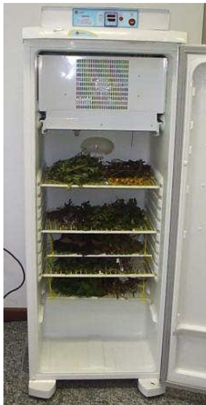
Figura 8 - Amostras de folhas, galhos e serapilheira secando em estufa de circulação forçada a 45°C.
