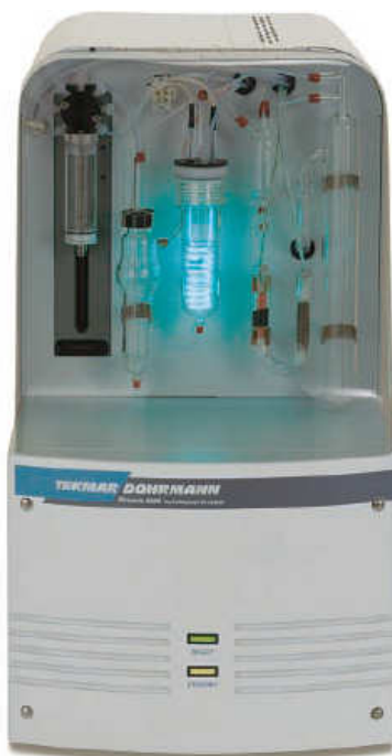
Figura 17 - Analisador de carbono específico (UV-PERSULFATE TOC - PHOENIX 8000 - TEKMAR DOHRMANN).
