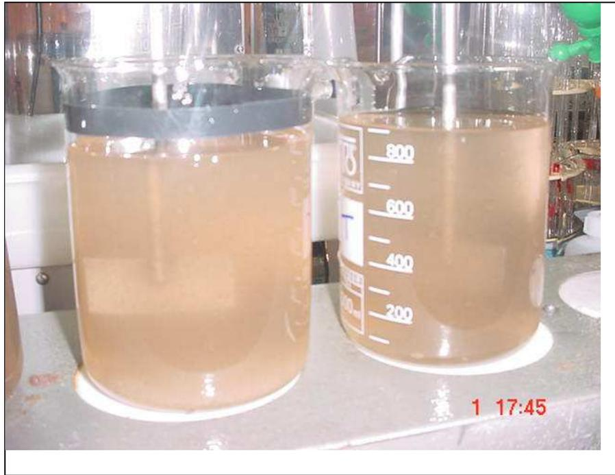
**Figura 4.7** Teste com Sulfato de Alumínio e Quifiltro
