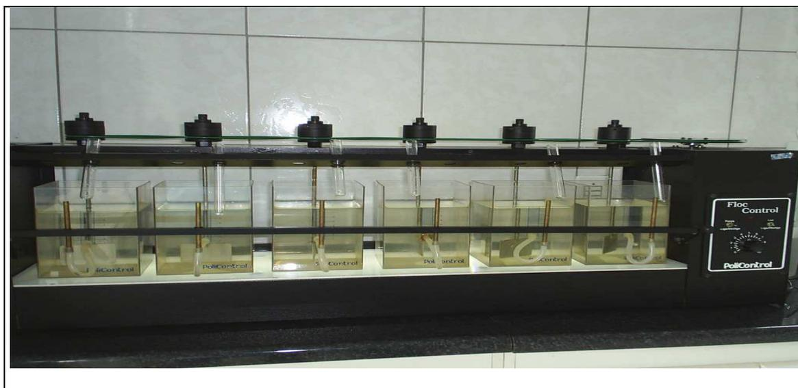
Figura 1. Equipamento de *jar test* usado nos ensaios em Itapema
