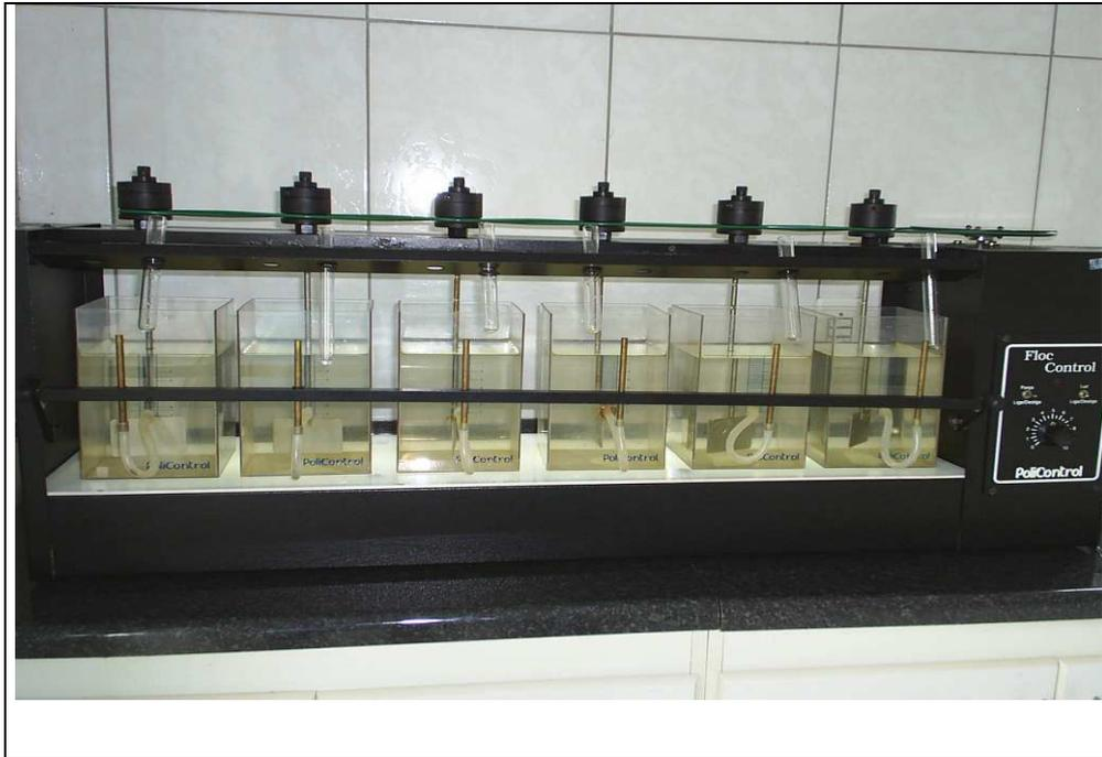
**Fig. 1. Equipamento de *jar test* utilizado nos experimentos em escala laboratorial**
