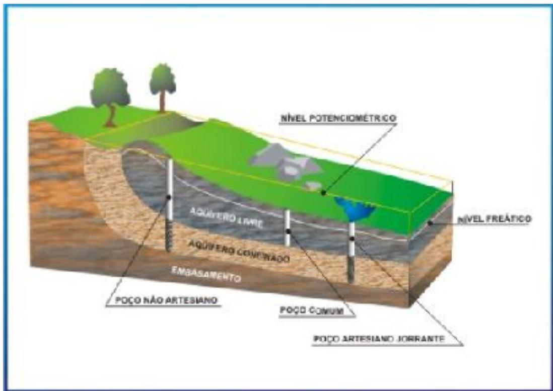
**Figura 4.7. Representação esquemática do nível de pressão nos aquíferos.**
