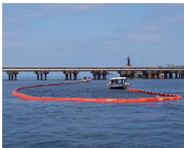
Figura 4.22 - Foto de duas embarcações realizando a formação em J. Fonte: Arquivo Caravana da Cidadania.
