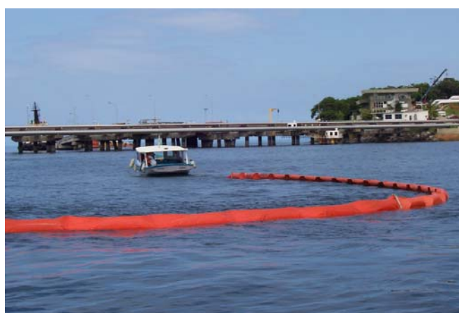
Figura 4.14 - Barreira de contenção. Fonte: Arquivo Caravana da Cidadania.
