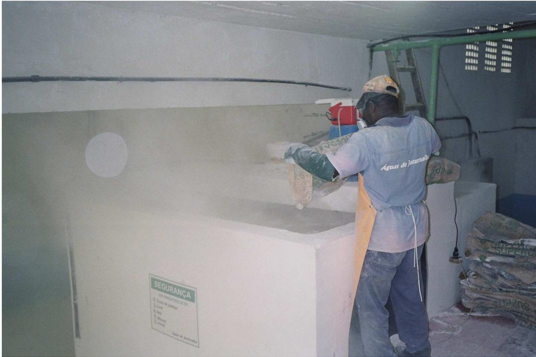
**Figura 7. Operação de diluição da cal hidratada**
