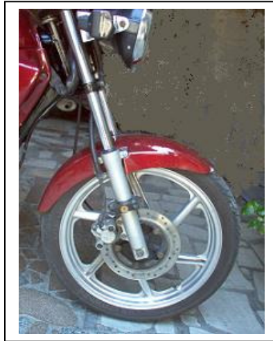
Figura 2.5.2 Ilustração do Sistema de Freios.
