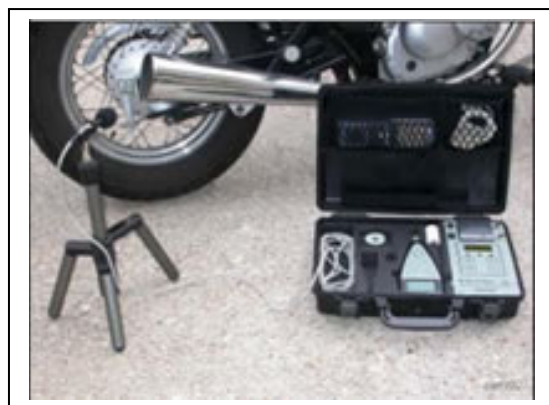
Figura 3.1.1 Gabarito da Posição do Microfone para Avaliação do Nível Ruído.
