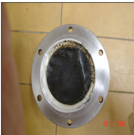
**Figura 7.5** - Aspecto do *fouling* na membrana após 20 minutos de permeação, formado em todas as amostras
