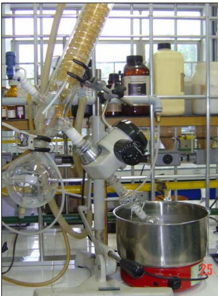
**Figura 6.5.** Evaporador rotativo.
