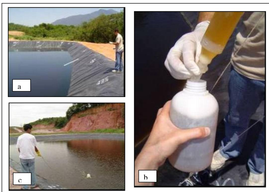
**Figura 5.15. Ilustração das amostragens realizadas para coleta de chorume. a) coleta na lagoa L2; b) armazenamento da amostra; c) coleta na lagoa L1. Fonte: Mattos, 2005.**
