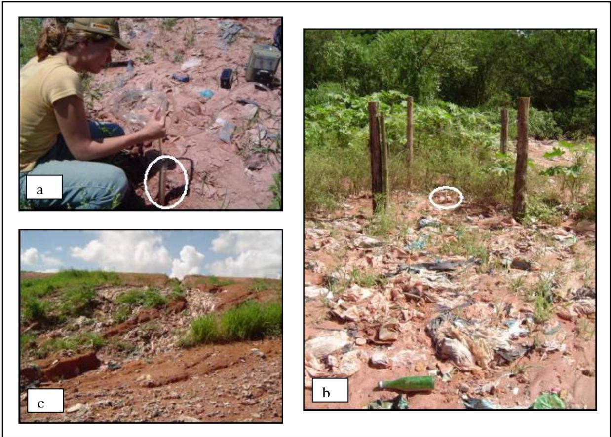
**Figura 5.7.** Poço de monitoramento PZ1. a) amostragem de novembro de 2004, observa-se algum material carregado; b) situação na época da amostragem de janeiro de 2005; c) erosão do talude adjacente ao poço, amostragem de janeiro de 2005. Fonte: Mattos, 2005.
