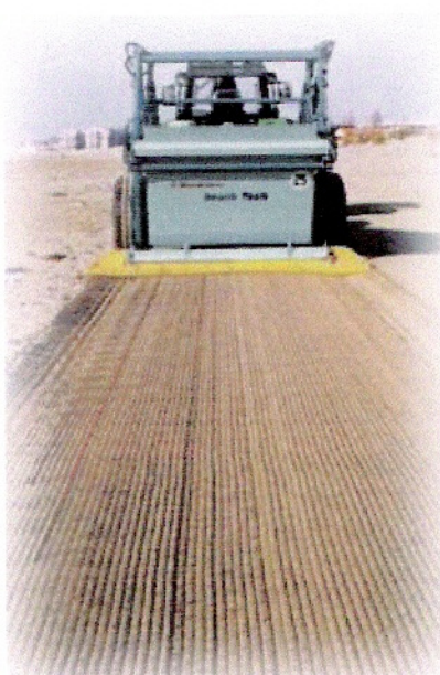
Figura 17 - Máquina de limpeza mecânica de areia de praia – 2.
