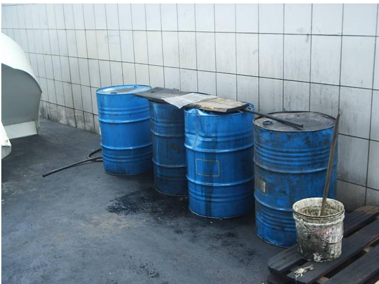
**Figura 6.2** Armazenagem temporária de óleos lubrificantes usados
